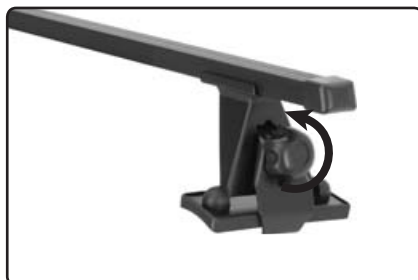
Uvolněte boční úchyty povolením šroubů M8x35 s plastovou hlavou.
