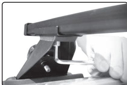
Pevně utáhněte šrouby M8x18 příloženým klíčem (imbus č.6).
