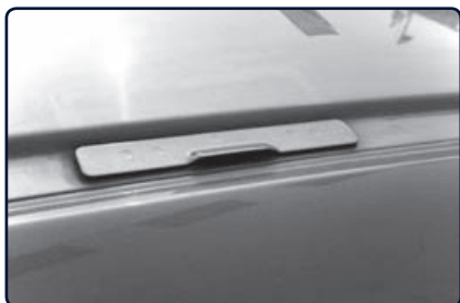
Detail přípravku, za který se upíná boční úchyt střešního nosiče.
